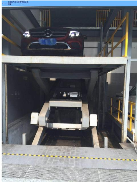
液压升降机在使用中要注意以下几点：液压升降机必须放置在坚实平整的地面上，以防工作时倾翻。准备升降前，请按下“上升”或“下降”按钮，使工作台升降。如果工作台不动，应立即停机进行检查。发现电动升降机工作压力过高或声音异常时，应立即关机检查，以免机械遭受严重破坏；每月定期检查轴销工作状态，如发现轴销、螺丝松脱，一定要锁紧，以防轴销脱落造成\*\*\*。液压油应保持清洁，每6个月更换一次；对液压升降机维修保养和清扫时，务必要撑起安全撑杆。固定升降机使用维护常识。1、升降机在使用时，工作台面应保持水平状态。2、室外作业，环境恶劣时，使用人员应系安全绳。3、机器升降过程中，严禁人员攀爬。4、固定式液压升降机升起后不得移动，四个支腿未撑紧不得起升作业。5、使用过程中严禁超载作业，所载物品应妥善放置。6、所用润滑油应保持清洁，不得混入水及其它杂质，一般每半年更换一次。7、维修保养时或出现故障时，应及时切断动力电源，升起后应将升降机固定牢方可进行。升降机, 固定式升降机, 铝合金升降机, 移动式升降机, 高空作业升降平台。固定导轨式升降机适用于哪里？浙江汽车升降机厂家
