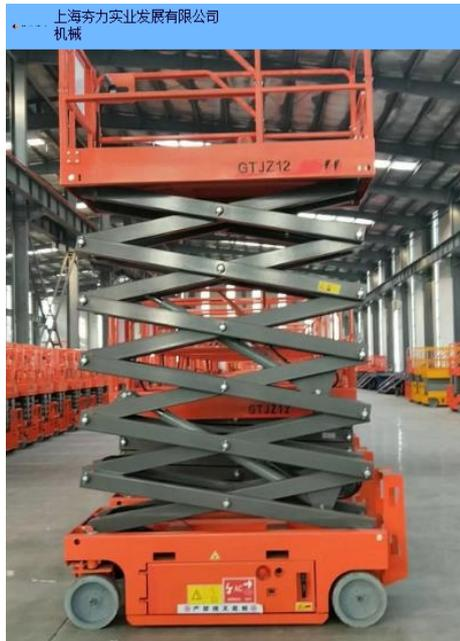
首先，要确保固定剪叉式升降机随车附带手册完整、易读且保存在平台中的手册盒内，检查液压油是否泄漏以及油位是否适当，并根据需要加油，还需要检查电池液是否泄漏以及液位是否合适，根据需要添加蒸馏水，同时确保所有标贴清晰、易读并位置适当。其次，检查固定剪叉式升降机的电器元件、接线、电缆、液压软管、接头、液压缸、液压阀块、蓄电池组、驱动马达、驱动电机、耐磨滑块、衬垫、轮胎、车轮、接地线、限位开关、警报器、喇叭、螺母、螺栓、平台超载部件、平台入门口、指示灯、警报器、安全臂、延伸平台、剪叉臂销钉、紧固件、平台控制手柄、刹车释放部件及坑洞保护装置等部件区域有无损坏、安装不当或零件丢失以及未经许可更改的情况。
